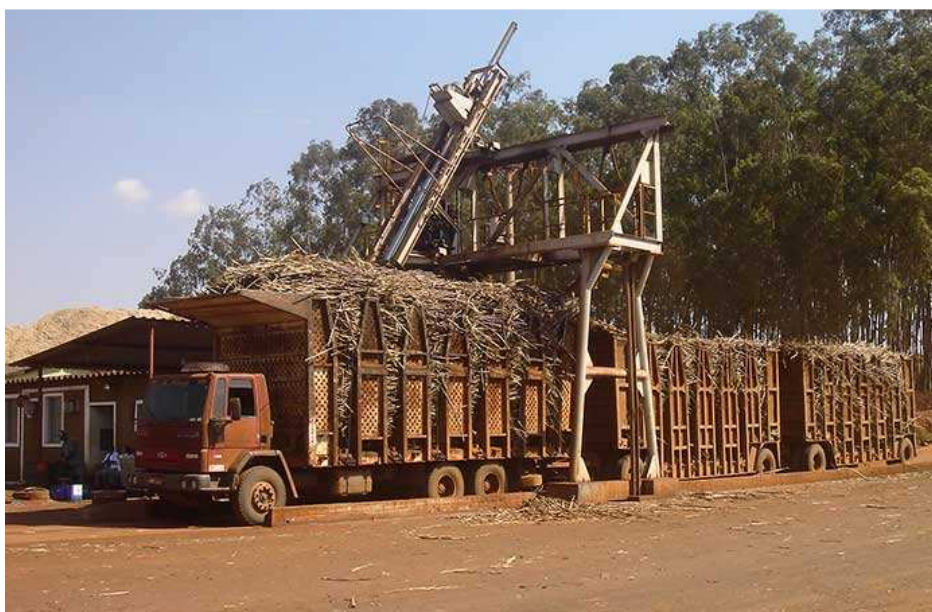
Figura 25 - Retirada da amostra da cana através de sonda oblíquas Fonte: SITE OFICIAL PITANGUEIRAS AÇÚCAR E ÁLCOOL, 2015
